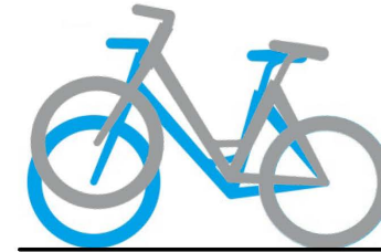
Figure 9 : Principe de disposition des vélos avec surélévation alternée de la roue avant
