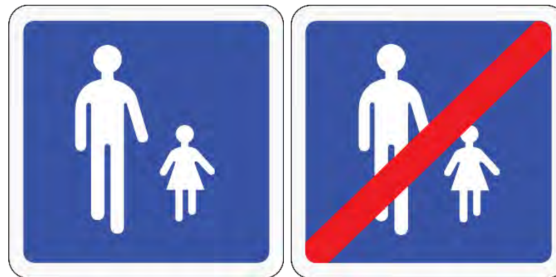
Aire piétonne – Panneau B54 B55
