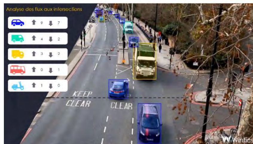
Analyse des flux routiers grâce au Deep Learning
